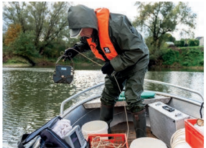
Entnahme von Schlammproben zur weiteren Untersuchung
